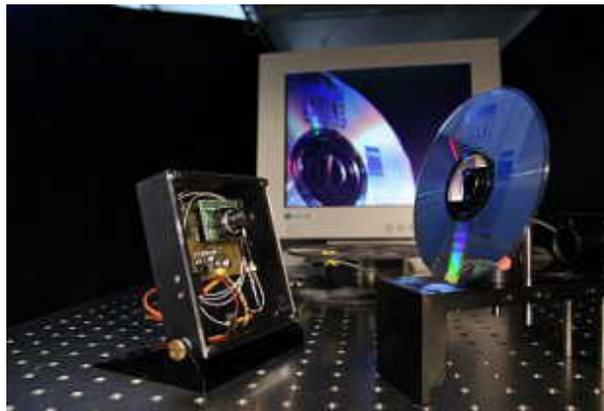
Die Videokamera (links) ist über eine Glasfaser mit einem PC verbunden.
